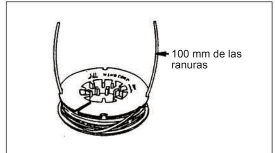
6. Coloque la perilla sobre el nodo de la carcasa, colocándolo de tal forma que se pueda mover hacia arriba y hacia abajo contra la tensión del resorte. Coloque el carrete en la carcasa, alineando los dientes de éste y la perilla de manera alterna, como los engranes.
