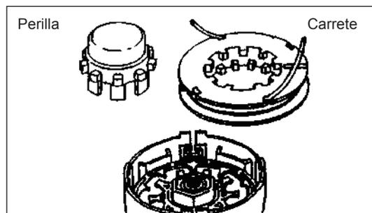
3. Coloque cada uno de los extremo de las dos líneas en los orificios de la ranura más interna en una de las bridas exteriores del carrete. Coloque las líneas en canales del carrete a través de cada hendija sobre las bridas.
