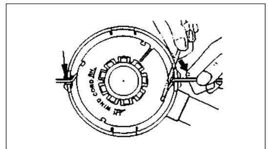
8. Coloque la cubierta en la carcasa, alineando las lengüetas en la cubierta y las ventanillas en la carcasa. Asegúrese de que la cubierta quede asegurada de forma precisa a la carcasa. La superficie de la lengüeta de bloqueo del borde exterior de la cubierta y la superficie de la carcasa deberán ser de la misma circunferencia.
