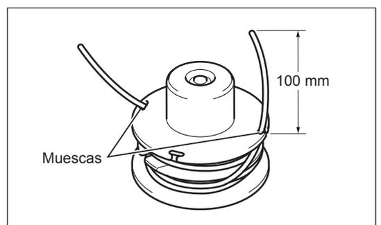
Coloque el carrete en la carcasa de tal forma que las ranuras y protuberancias en el carrete encajen con los de la carcasa. Mantenga el costado con las letras en el carrete visibles sobre la parte superior. Y ahora desenganche los extremos del cordón de su posición temporal e introdúzcalos por los ojales para que salgan de la carcasa.
