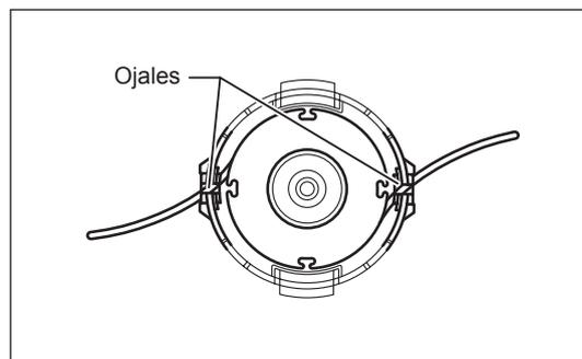
Alinee la protuberancia sobre el lado inferior de la cubierta con las ranuras de los ojales. Luego empuje la cubierta con firmeza en la carcasa para fijarla. Asegúrese que las aldabillas queden completamente extendidas en la cubierta.
