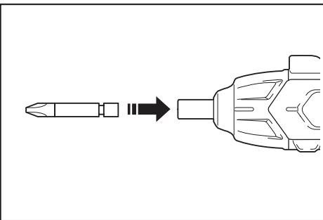
Para instalar la punta para atornillar, empújela firmemente en el portapuntas del atornillador. Para extraer la punta para atornillar, sáquela del portapuntas del atornillador.
