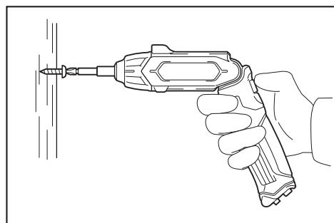
Coloque la punta de la punta para atornillar en la cabeza del tornillo y aplique presión a la herramienta. Luego encienda la herramienta. Cuando la cabeza del tornillo y la superficie de la pieza de trabajo queden nivelados, suelte el interruptor.
