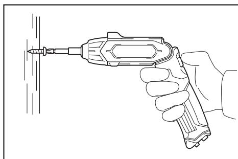
Mettez la pointe de l'embout-tournevis dans la tête de vis, et appliquez une pression sur l'outil. Allumez ensuite l'outil. Lorsque la tête de vis se trouve au même niveau que la surface de la pièce, libérez l'interrupteur.
