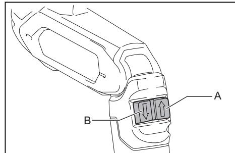
Para arrancar la herramienta, simplemente presione el interruptor en el lado A para una rotación en el sentido de las manecillas del reloj y en el lado B para una rotación en sentido inverso al de las manecillas del reloj. Para detenerla, suelte el interruptor.
