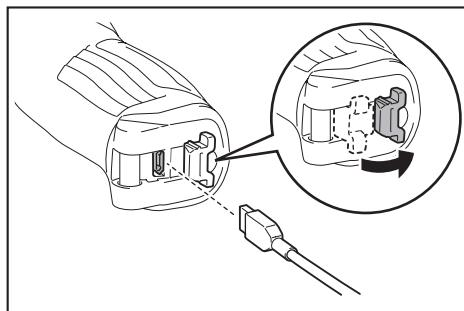
Conecte el cable USB al adaptador de CA y luego conecte el adaptador de CA al suministro de electricidad. Abra la cubierta del conector en la herramienta y luego conecte el cable USB al conector.
