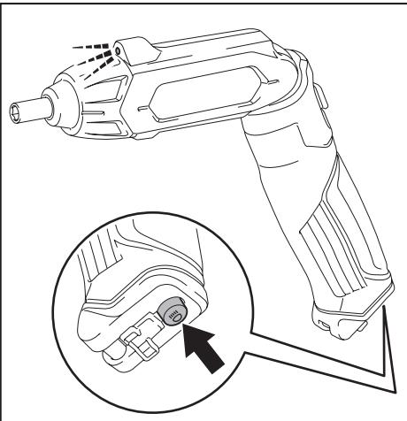
Para encender la luz, presione el interruptor de la lámpara. Para apagar la luz, presione el interruptor de la lámpara nuevamente.
