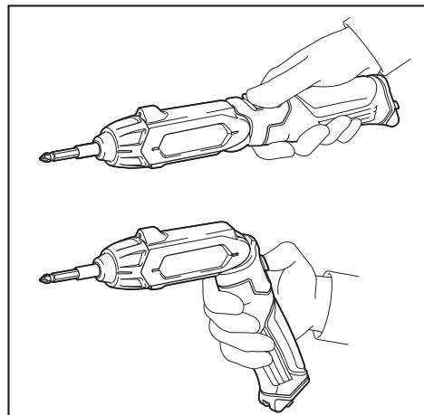
La herramienta puede utilizarse de dos maneras: en forma recta y en forma de pistola, las cuales se pueden seleccionar de acuerdo con las condiciones del lugar de trabajo y el atornillado.
