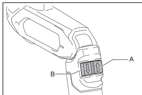
Pour démarrer l'outil, appuyez simplement sur l'interrupteur du côté A pour une rotation dans le sens des aiguilles d'une montre, et du côté B pour une rotation dans le sens contraire des aiguilles d'une montre. Pour l'arrêter, libérez l'interrupteur.
