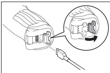
Connectez le câble USB à l'adaptateur secteur, puis branchez l'adaptateur secteur dans la prise secteur. Ouvrez le cache-connecteur sur l'outil, puis connectez le câble USB au connecteur.
