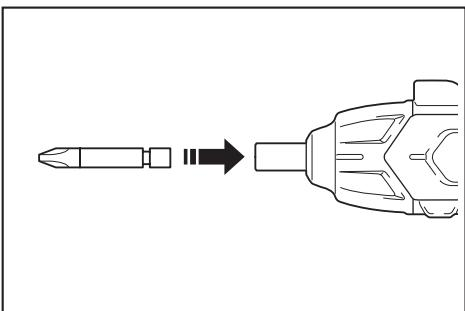
Pour installer un embout-tournevis, enfoncez-le fermement dans le porte-embout-tournevis. Pour retirer l'embout-tournevis, tirez dessus pour le faire sortir du porte-embout-tournevis.
