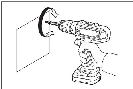
Apague la herramienta. Mueva la palanca del interruptor de inversión a la posición neutral. Gire el anillo de ajuste de forma que la flecha quede apuntando hacia la
