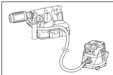
3. Ajuste el interruptor de modo en espera en la aspiradora en "AUTO".
