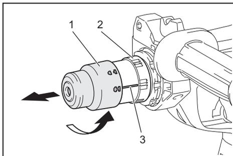
► 1. Portabrocas de cambio rápido para SDS-plus
