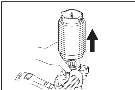
**NOTA:** Si la tapa llega a salirse del contenedor de polvo, fijela con su lado impreso orientado hacia arriba de manera que la ranura en la tapa encaje en la periferia interior del accesorio.
