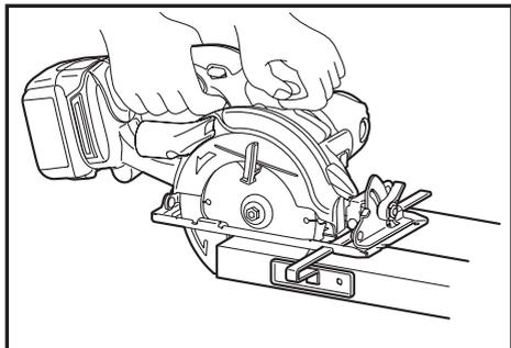
La útil guía lateral le permite hacer cortes rectos extra-precisos. Simplemente saque la guía lateral deslizándola hasta ajustarla bien contra el costado de la pieza de trabajo y sujétela en posición con el tornillo de la parte delantera de la base. Con ella también se pueden hacer cortes repetidos de anchura uniforme.
