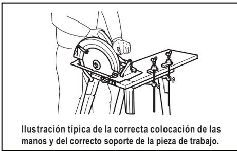
Ilustración típica de la correcta colocación de las manos y del correcto soporte de la pieza de trabajo.
