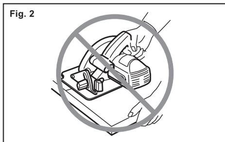
28. **Antes de depositar la herramienta tras realizar un corte, asegúrese de que el protector inferior esté cerrado y de que el disco se haya detenido por completo.**
