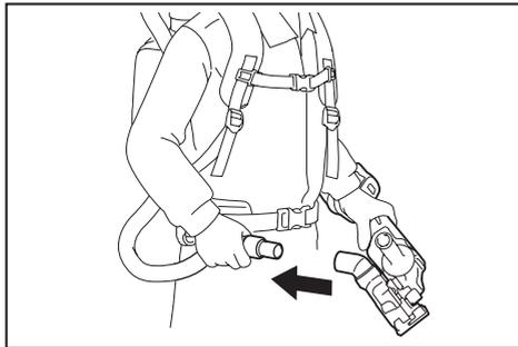
4. Ajuste el interruptor de modo en espera en la aspiradora en "I (ON)". La luz indicadora de activación inalámbrica parpadeará en azul.
