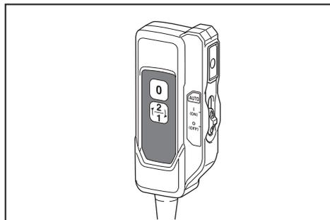
**NOTA:** Si desea operar la aspiradora con el interruptor de la herramienta conectada a la aspiradora (función de activación inalámbrica), ajuste el interruptor de modo en espera en "I (ON)".
