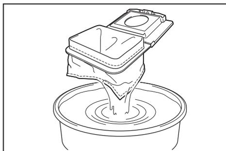
**AVISO:** Una bolsa recolectora de polvo húmeda reduce el desempeño del aspirado así como la vida del motor.
