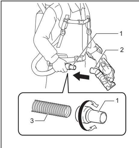
► 1. Boca delantera 2. Salida de extracción 3. Manguera
