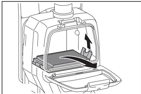
2. Golpee el polvo del filtro. El filtro puede ser lavado con agua. Limpie con agua el polvo y las partículas en el filtro cada 1 o 2 meses. Después de eso, seque por completo el filtro en un lugar a la sombra y bien ventilado para evitar un olor desagradable o un funcionamiento defectuoso.
