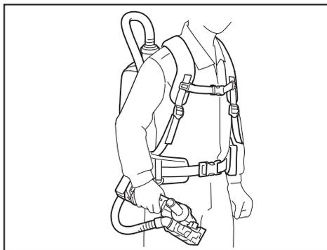
2. Oprima el botón  $\left(\frac{2}{1}\right)$  para comenzar a aspirar. Para cambiar la potencia de succión, pulse el botón  $\left(\frac{2}{1}\right)$  mientras la aspiradora está en funcionamiento. La potencia de succión se conmuta entre normal (1) y alto (2). Oprima el botón  $\left(\frac{0}{0}\right)$  para parar.
