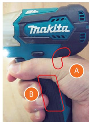
**A** A fin de proporcionar el máximo empuje a la punta, la empuñadura en la parte superior trasera es ergonómica y amplia, para que quepa perfectamente en la forma de U de la mano del usuario formada entre el pulgar y el dedo índice.
