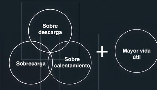
La batería cuenta con una tecnología que permite la comunicación entre la batería y la herramienta, monitoreando las condiciones e intercambiando datos en tiempo real para protegerla contra sobrecarga, sobredescarga y sobrecalentamiento, esto permite alargar la vida útil de la batería.
