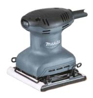
Potencia de entrada 180W Tamaño de respaldo 112 x 102mm (4-3/8 " x 4") Papel lija 114 x 140mm (4-1/2" x 5-1/2") Orbitas por minuto (opm) 14,000 Dimensiones 110x112x133mm (4-5/16"x4-3/8"x5-1/4") 0.89kg (2.0lbs)  $(L \times A \times A)$ Peso neto Cable de conexión 2.0m (6.6ft)
