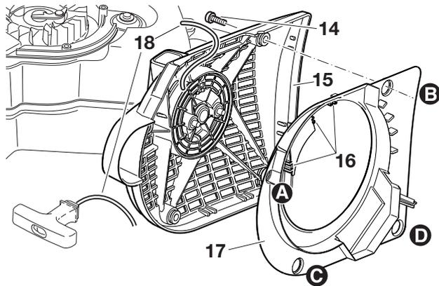
Enhebrar el nuevo cable de arranque ( $\varnothing$  4,0 mm, 1000 mm largo), como se muestra en la figura (no olvidar la polea (19)) y asegurar ambos extremos con nudos.
