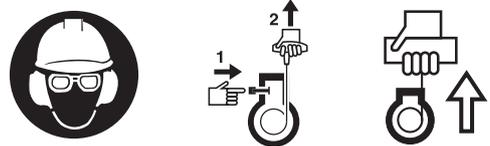
Realizar el ajuste del carburador con el destornillador incluido en el volumen de suministro (1). Posee una protuberancia fundida que sirve como ayuda de ajuste.
