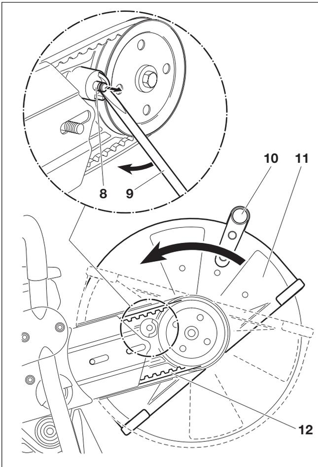
Extraer el perno de tope (8) haciendo palanca con la llave combinada (9) como se muestra en la figura, hasta que pueda girarse la cubierta protectora (11).
