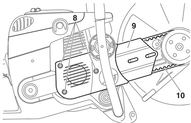
Aflojar los tornillos (8) y quitar la cubierta de la caja del cigüeñal (9).
