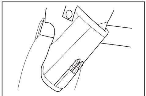
Puede guardar dos puntas para atornillar en la parte delantera de la funda.
