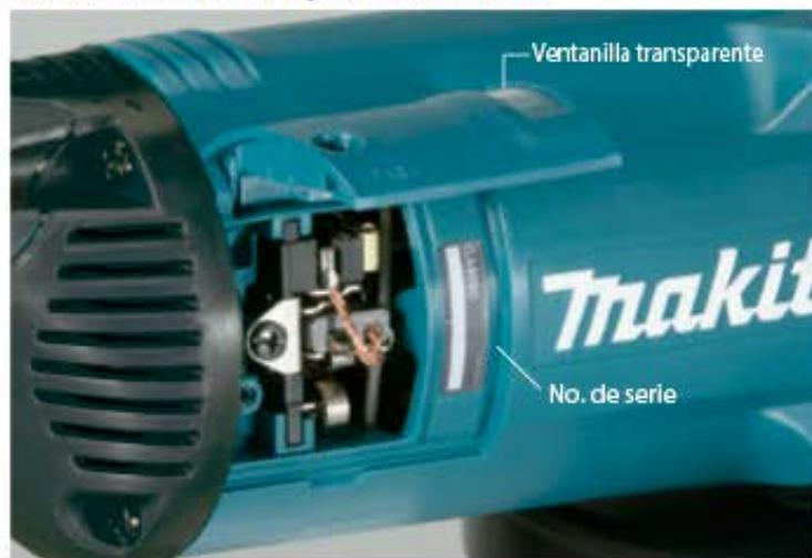
Nuevo diseño del portacarbones, sustituyendo la tapa roscada por una tapa con tornillo, más seguridad contra golpes y calentamiento, además de alargar la duración del carbón.
