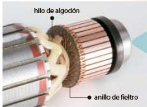
La fuerza de fijación de la bobina ha sido significativamente mejorada mediante la adición de la hilo de algodón y el anillo de fieltro.
