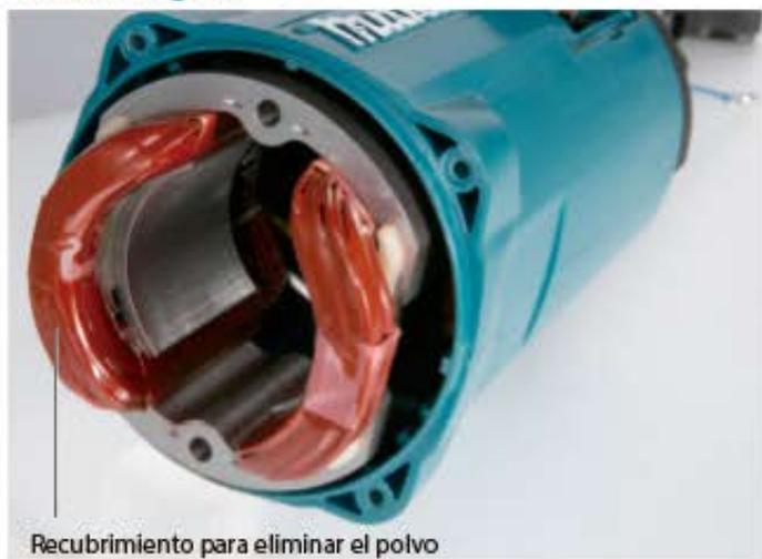
Utiliza material de absorción baja, para reducir la absorción del agua que hay en el aire, previniendo la expansión de la carcasa que pueda causar la abrasión de la misma a través del núcleo de la armadura.
