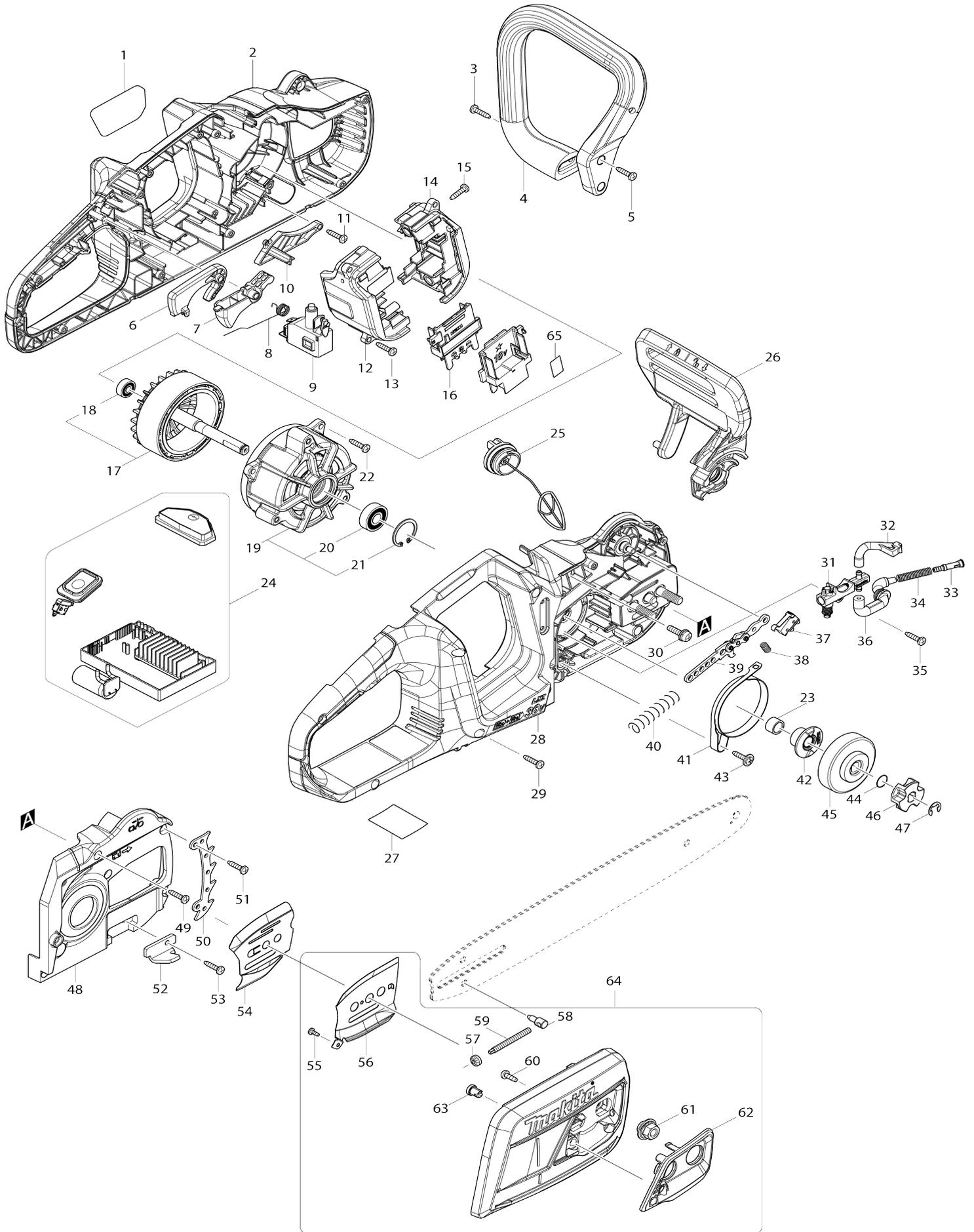
Model No.DUC405 400MM CORDLESS CHAIN SAW
