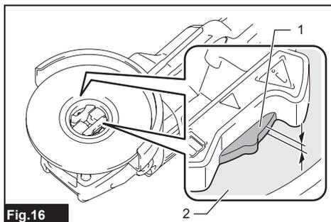
Para extraer la rueda del X-LOCK, empuje la palanca de liberación del lado A para levantar el lado B, luego tire de la palanca de liberación del lado B como se ilustra.
