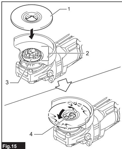
4. Asegúrese de que la rueda del X-LOCK quede fija correctamente. La superficie de la rueda del X-LOCK no queda más alta que la superficie del soporte, como se muestra en la ilustración. De lo contrario, se debe limpiar el soporte o no se debe usar la rueda del X-LOCK.
